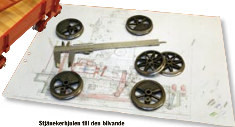
Stjärnekerhjul till den blivande modellen av Stockholms första ångspårvagn. Samtliga hjulringar till såväl passagerarvagn som motorvagn är svarvade i stål med utgångspunkt från arkiverade originalritningar.
