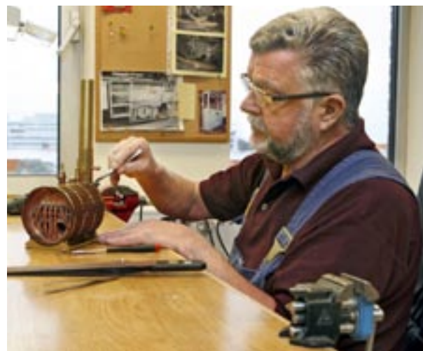
Jan Pihlgren slutjusterar en liggande Scott ångpanna i sin verkstad i industrihuset Borgen i Norsborg i södra Stockholm. Ångpannan har han byggt efter originalritningar han lånat från Sjöhistoriska Museet.
