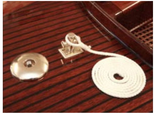
Här några däckdetaljer i mässing på ångslupen Larissa. Själva däckets är byggt av ribbor i odlad hondurasmahogny och lackat tolv gånger med Letonkinois, en kinesisk superlack.
